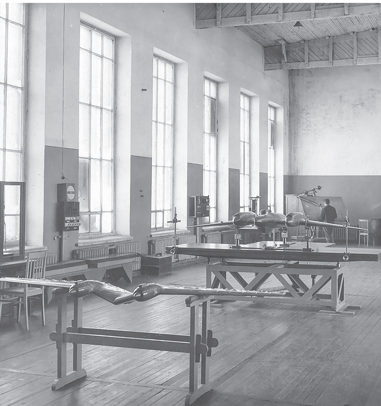
Препараторская плита с необходимым комплектом приспособлений для обмера моделей. Новосибирский филиал № 2 Центрального аэрогидродинамического института им. Н. Е. Жуковского. Новосибирск, 1944 г. ГАНО. Ф. П. 4. Оп. 9. Д. 355. Л. 28.
