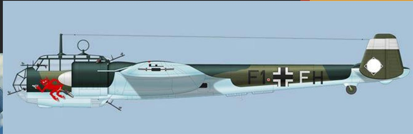
«Краткая справка: Немецкий бомбардировщик «Дорнье 215» образца 1938 года. В качестве бомбардировщика самолет почти не применялся, быстро устарев и перейдя в класс разведывательных самолетов. Экипаж – 4 человека, максимальная скорость – 467 км/ч, дальность полета – 2400 км, взлетная масса – 8800 кг, размах крыльев 15,8 м, длина – 18 м, высота – 4,6 м, площадь крыла 53,3 кв.м, вооружение - 6х 7,92-мм пулеметов MG-17 (2 вперед, по 1 с верху и снизу, 2 в боковых окнах), 1000 кг бомбовой нагрузки
